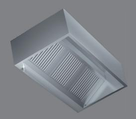
Wandkastenhauben gepunktet, aus Edelstahl mit Beleuchtung, Labyrinth-Filter, Fettablasshahn, Motor und Regler, 300 x 270 mm Ausblasöffnung
